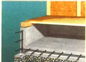
床の直下に断熱材を入れ、建物の断熱性能を高めます。
